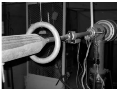
Рис. 2 Вигляд нейтронного генератору ІНГ-200 з кільцевим зразком із кадмію ^{nat}\text{Cd} з природнім ізотопним складом ( a ) та схема розміщення нейтронного генератору та зразка та детекторів при MCNP симуляції ( б ).
